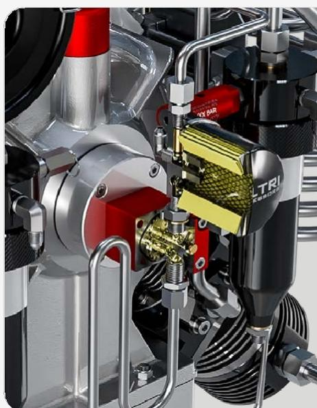
Lubrification forcée avec pompe à engrenages basse pression
